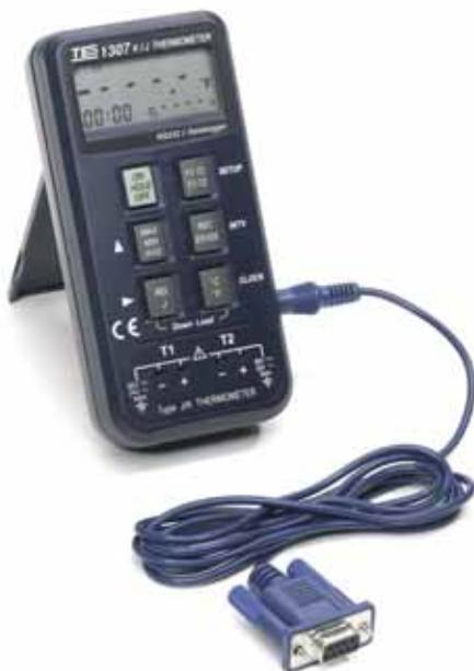
Termometro digitale dotato di doppio ingresso per termocoppie tipo K/J con la possibilità di effettuare misurazioni singolarmente o in modo differenziale.
