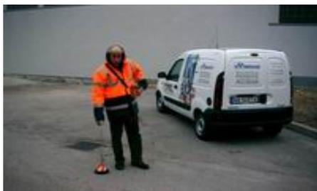
ARW 40 è uno strumento che viene utilizzato anche dalla Protezione Civile in caso di calamità, infatti tramite esso è possibile individuare eventuali persone superstiti sotto le macerie, tramite la rilevazione del respiro e del battito cardiaco.
